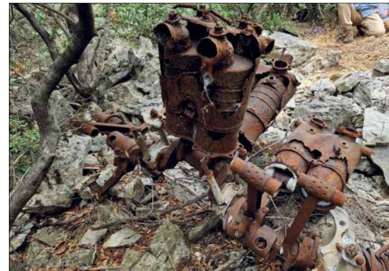
Le moteur Renault V12 300 ch, complet à 40 %.
