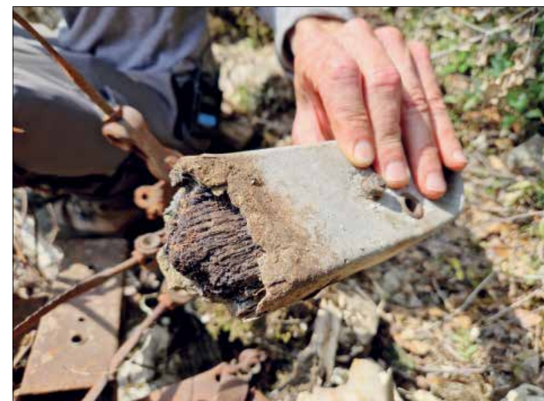
Dans ce manchon en duralumin, du bois brûlé prouvant qu'il y a eu un incendie.
